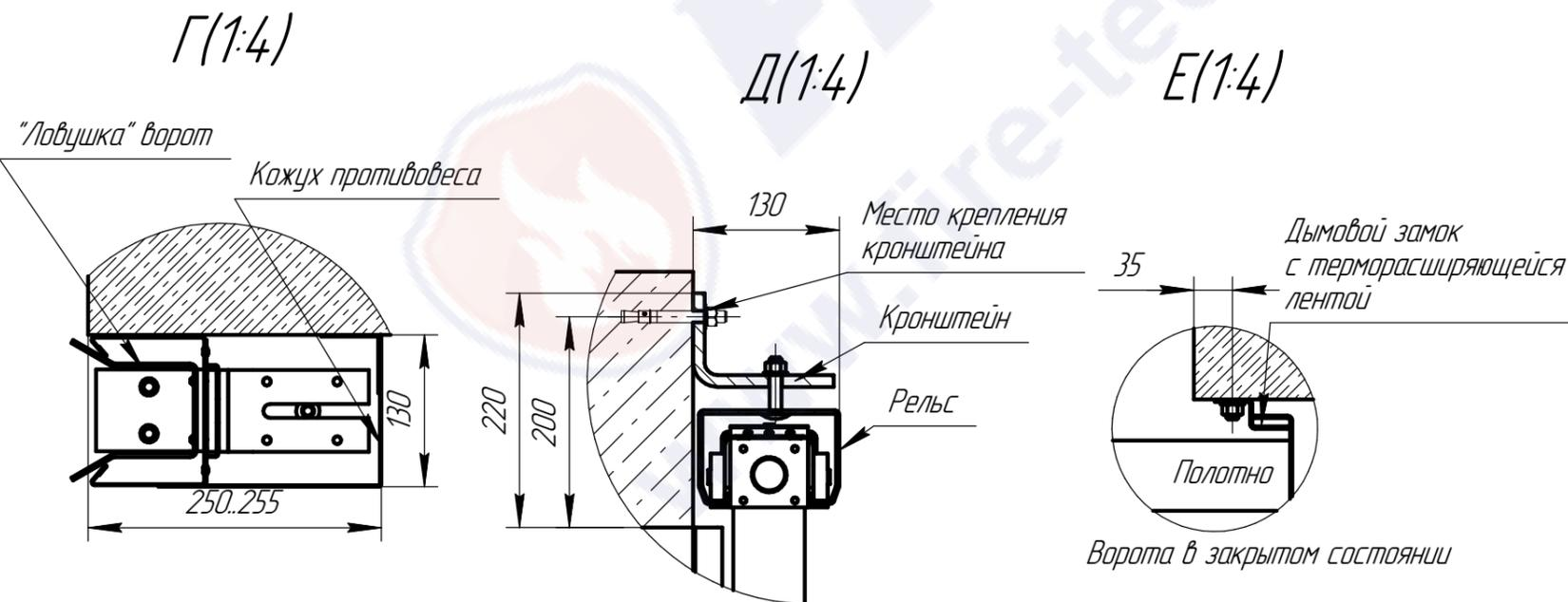
1. Металлоконструкция (или бетон) должна быть выполнена в единой плоскости "X". Допустимое отклонение по вертикали от плоскости "X"  $\pm 5$ мм на всем размере конструкции. Допустимое отклонение в местах сварных соединений  $\pm 5$ мм.
